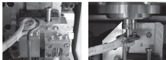
図2 自動焼きばめ装置（左）と工具取り付け状態（右）
