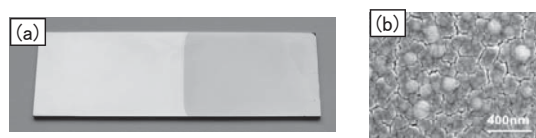
図1 めっき皮膜の黒色化処理 (a)外観写真, (b)黒色化部分のSEM像
