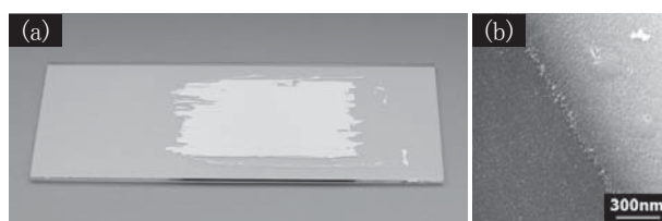
図3 固体接触法によりガラス基板上に形成しためっきの(a)外観写真と(b)析出境界部のSEM像
