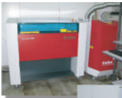
▲ 皮革用レーザー加工機
