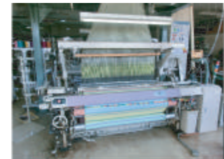
▲ 電子ジャカード付レピア織機
