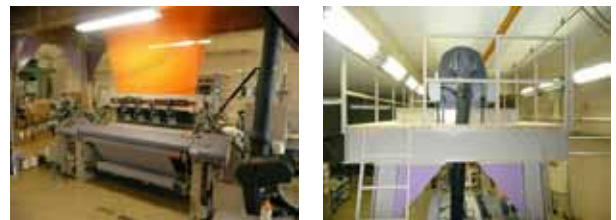
図 1 改造したエアージェット織機 図 2 改造したジャガード装置
