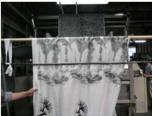
図1 生地在庫にプリントしたものをクラッシュ加工する実験風景（播州織工業協同組合）
