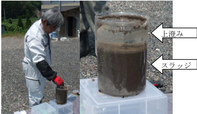
図4 凝集作業風景
