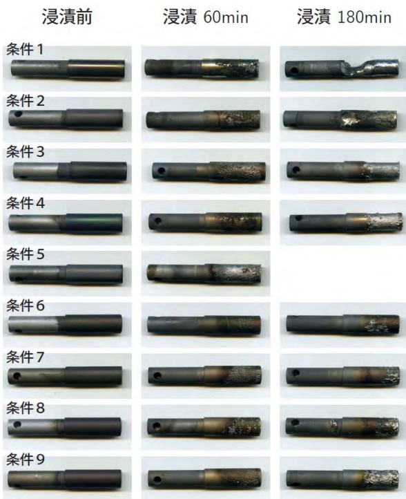
図4 アルミニウム溶湯への浸漬する前および、60min、180min 浸漬後の試験片のマクロ写真
