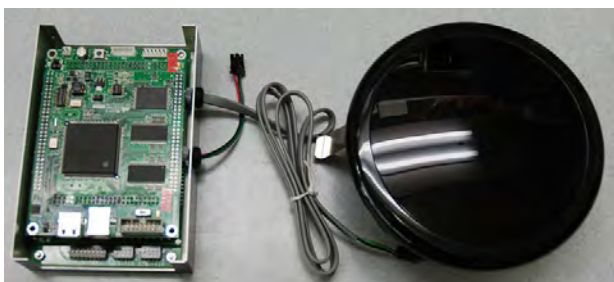
図1 開発した天井埋込型センサ(右側)とインタフェースモジュール
