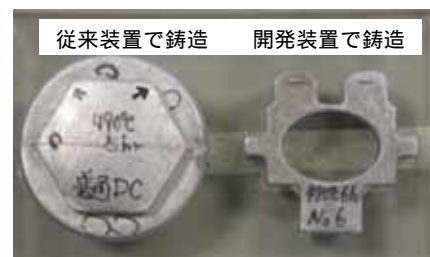
図 6 490 T6 処理品の外観比較 左側従来装置では黒丸部でふくれが発生
