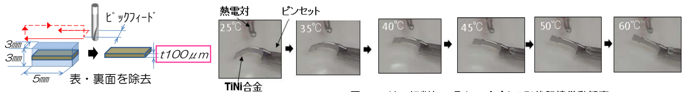
図6 マイクロ切削加工品(TiNi合金)の形状記憶挙動観察
