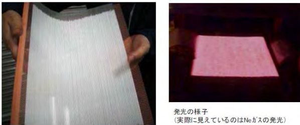
図7 試作した230本アレイ紫外PTA面光源の外観
