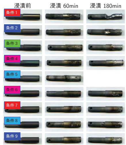
窒化ホウ素膜の成膜の条件と各試料の溶損過程の様子
