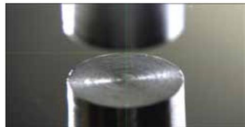
図2 切削工具と鏡面に映る切削工具のモニタ画像
