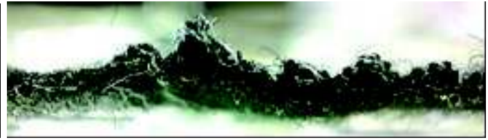
図 11 ウール・ポリウレタン複合交織織物の断面
