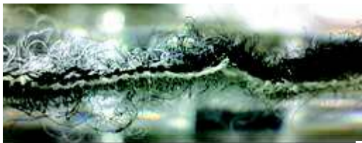
図 10 ウール交織織物の断面
