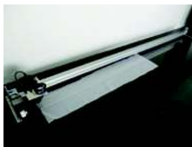
図5 高精度織物読み取り装置
