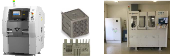
金属積層3Dプリンタ(出典:株式会社) 砂型積層3Dプリンタ
