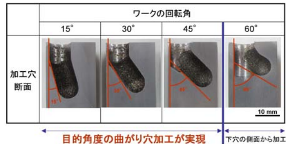
図6 ワークの回転角と加工穴の断面形状
