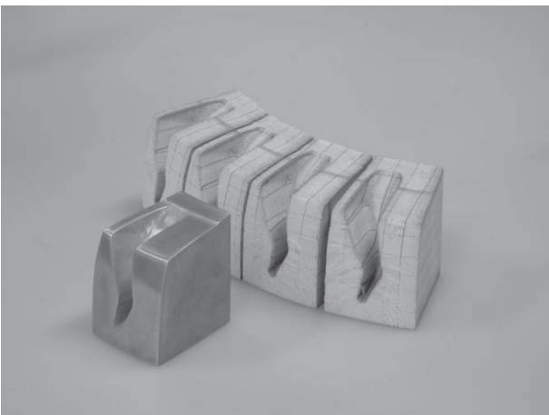
図9 タイヤ金型の紙積層RPモデルおよび鋳造品
