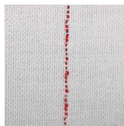
タテ糸張力変化で糸が浮き上がる織物 (B 位置)
