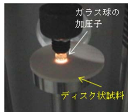
図 1 圧縮荷重による応力発光
