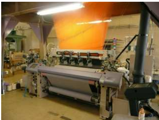
図 1 改造したエアージェット織機
