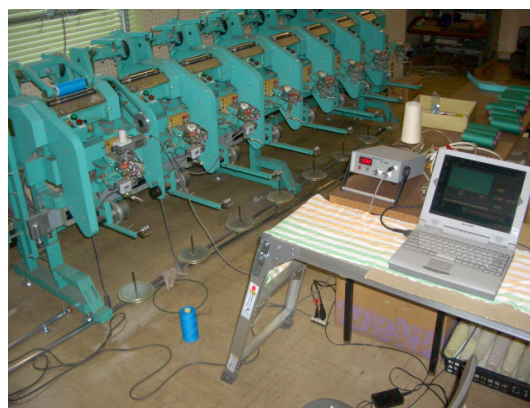
図2 張力計測時の様子
