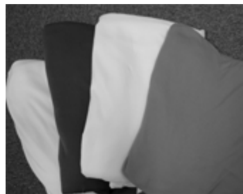
図4 ソフト強撚糸ニット (株森下メリヤス工場製)
