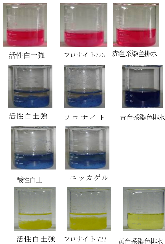
図4 活性白土による赤色および青色、黄色の反応染色排水の吸着実験結果
