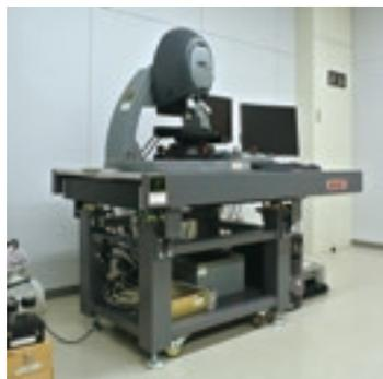
非接触三次元表面形状・粗さ測定機
