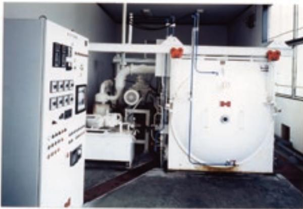
ガス及び油冷却形真空熱処理炉
