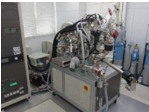
本測定装置は固体試料表面に単色化した軟X線を照射し、光電効果で励起される光電子の運動エネルギーを分光することで、試料表面の元素組成並びに化学結合状態を定性・定量分析する装置である。特に本装置は、10 $\mu$ m程度のX線ビームを走査することで、2次元方向での元素組成及びその化学結合状態の情報を得ることが可能であり、X励起による電子像（走査X線イメージ, SXI）を得ることができる。さらに同一元素についても化学結合状態の違いによる元素マッピングも得ることが可能である。
