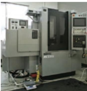
超高速回転三次元形状精密加工装置
