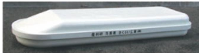
摩擦攪拌接合による難燃性マグネシウム合金製ルーフボックス
