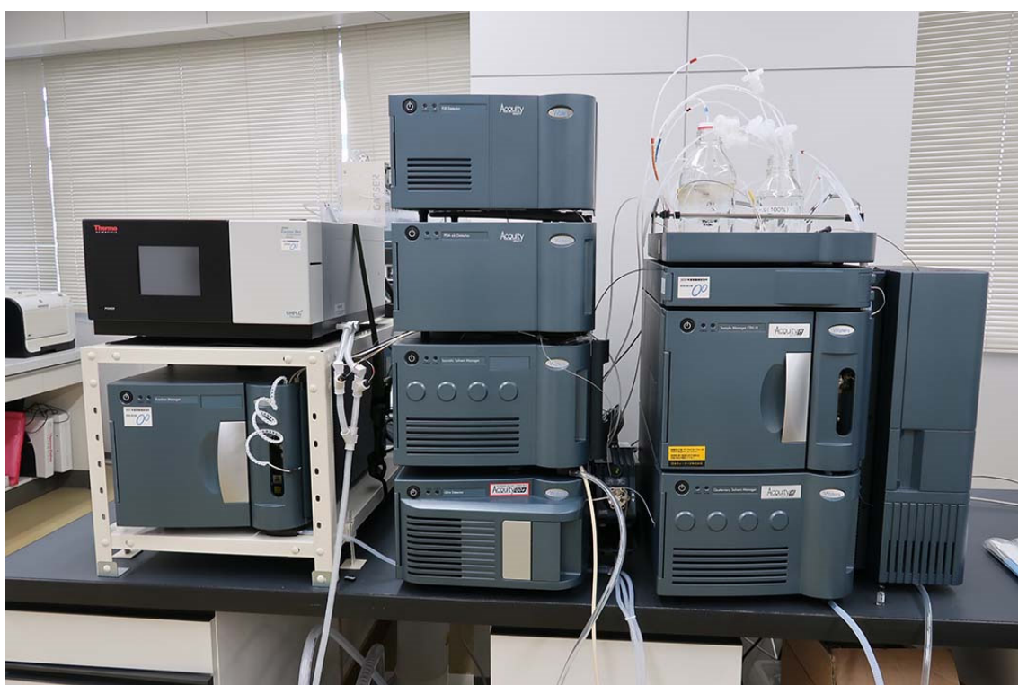
超高速液体クロマトグラフ(UPLC)
