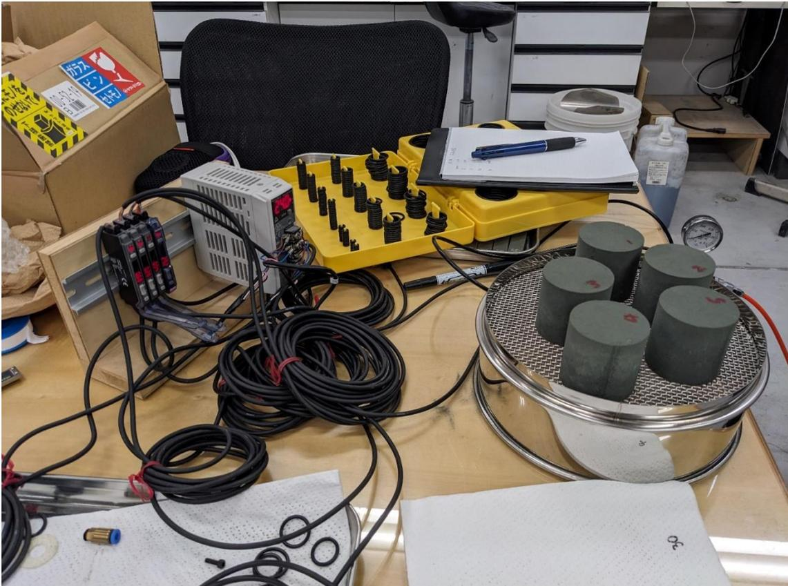
図8 プロブ型通気度試験 評価用試験片および評価試験機
