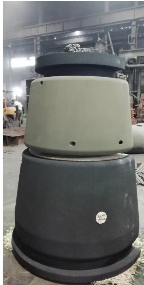
図 1 3 従来法（木型により手込め）砂型とハイブリッドさせた積層造形砂型（色が薄い方）
