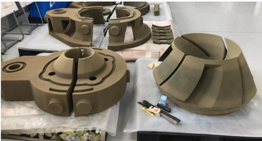
図9 インペラ用積層造形砂型
