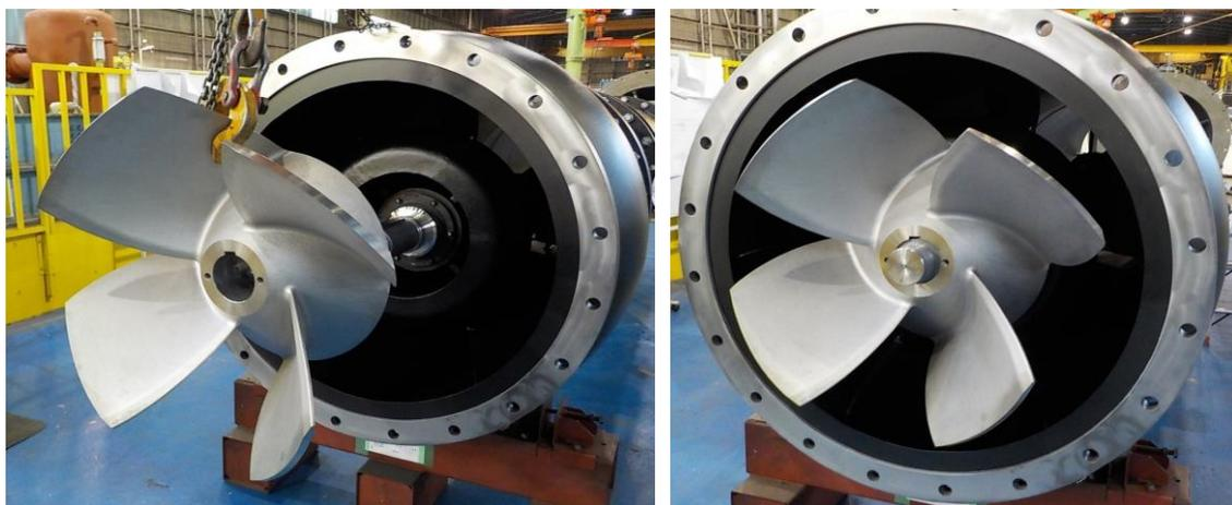
図10 積層造形砂型を使って作製したインペラおよび組み込みポンプ
