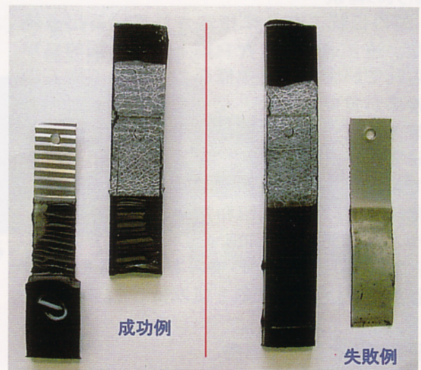
直接加硫接着の成功例と失敗例
