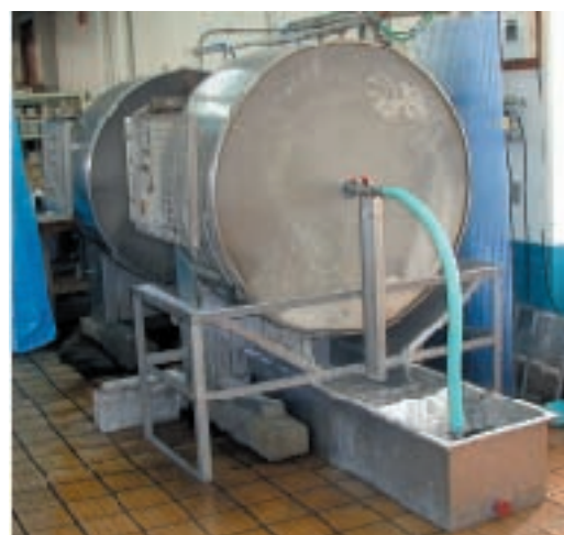
図2 石灰浴液の循環による毛回収
