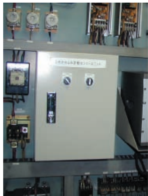
棒鋼結束装置に組み込まれた棒鋼計数装置
