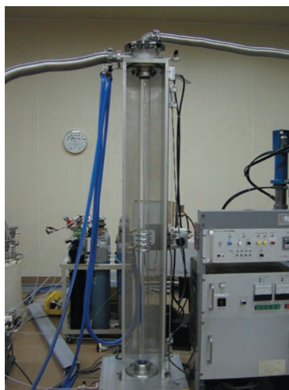
図1. 細長い形状物（チューブ含）成膜用プラズマ重合装置
