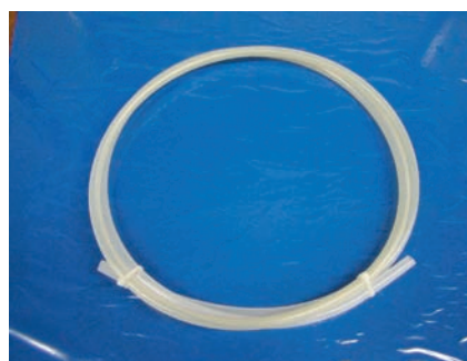
図2. 内面にプラズマ重合膜をコーティングしたPPチューブ
