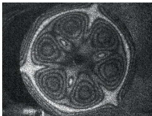
ステンレス円盤の振動モード測定例 (振動周波数1542Hz)
