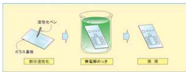
図1 固体活性剤を用いた活性化前処理による部分めっき工程
