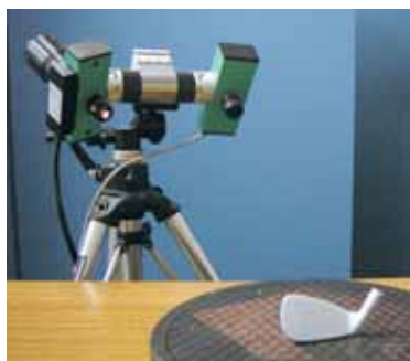
図1 3次元測定器で形状を測定
