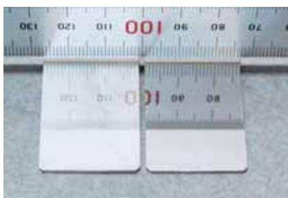
無電解Niめっきしたスライドガラス (左：従来法、右：改良法)
