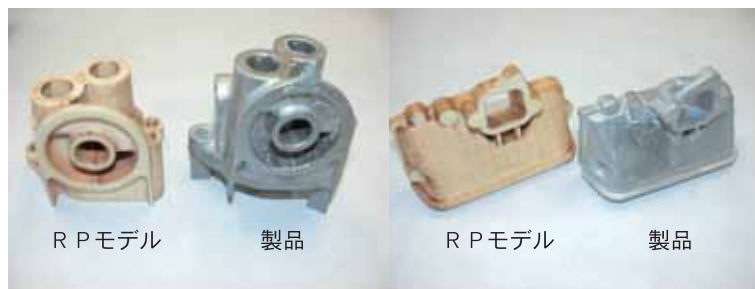
エンジン部品のアルミニウムダイカスト製品試作事例
