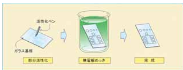
固体接触法によるめっき工程
