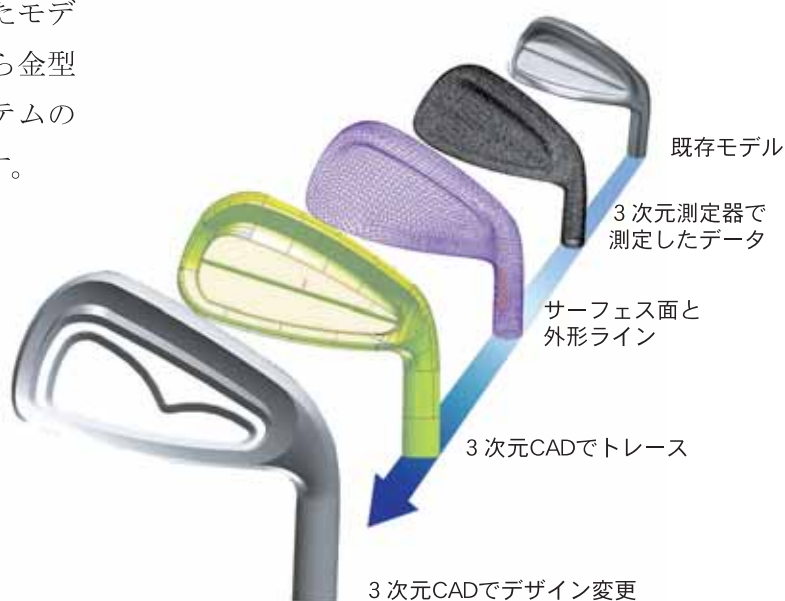
図2 3次元測定器データからデザイン修正までの流れ
