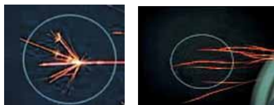
上：鋼材の火花試験の作業状況 下：鋼材毎に違う火花の形や色
