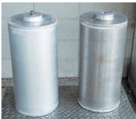
摩擦攪拌接合によって製作した真空容器 (右：マグネシウム合金、左：アルミニウム合金)
