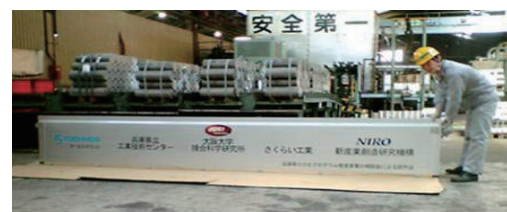
世界最大の難燃性Mg合金製煽り板
