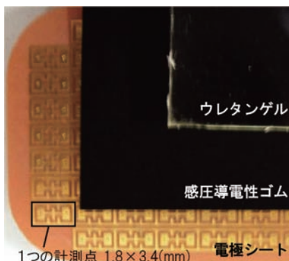
分布型圧力センサの構造
