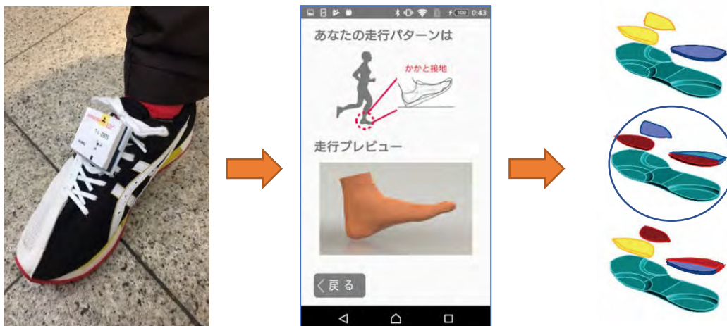
IMU センサ機能を活用して走行時の着地パターンを自動判定し、走法にあったソールを選択
