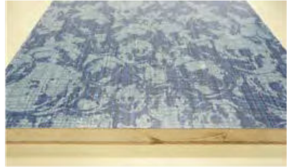
先染織物を表面に加飾した炭素繊維強化木材
