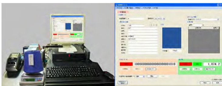
残糸の管理・検索システム（残糸重量と IC タグの登録）
