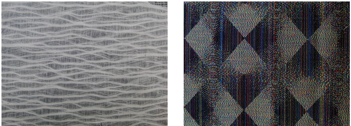
図 2 ニホンシカ革に型押ししたクラッシュ織物と AW 柵系を用いたぼやけ織物
