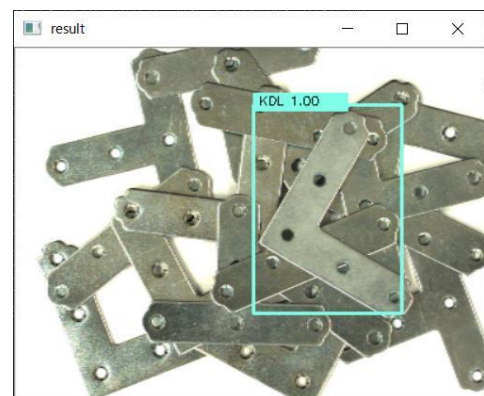
図2 L型金具の検出結果
