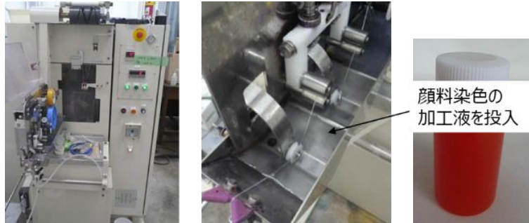
図 1 使用した一本糊付機および染色加工液
