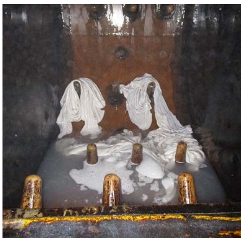
図11 鞣し途中のドラム内部
