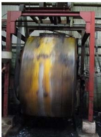
図2 中村貢皮革工業所 木製ドラム
