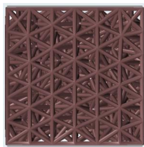
(b) 長さ 4mm 太さ \Phi 0.8\sim 1.6\text{mm}
