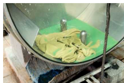
図2 還元析出処理中のドラムの様子
