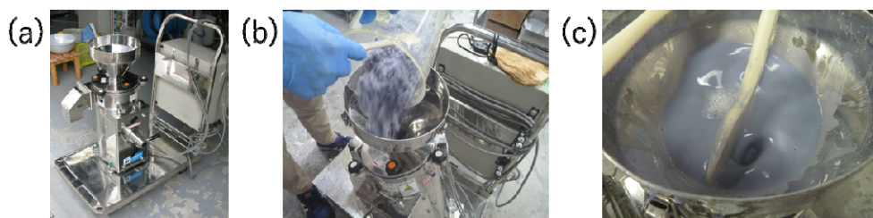
図 2 ディスクミル(スーパーマスコロイダー)による機械的解繊の様子 (a) スーパーマスコロイダー (b) 装置への懸濁液の投入 (c) スラリー状になった試料
