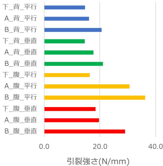
図6 試作革の引裂試験結果
