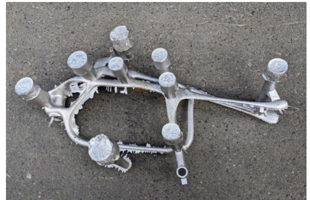
図 25 鋳込んだ直後の 1 号機フレーム
