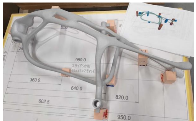
図 26 仕上げ加工した 1 号機フレーム
