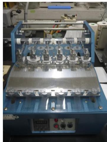
図 1. 摩擦堅ろう度試験機
