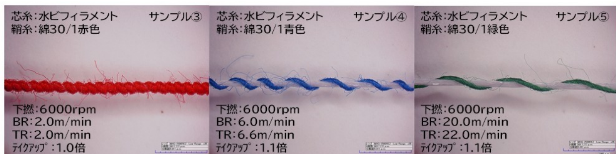
（図3）作製したカバーリング撚糸
