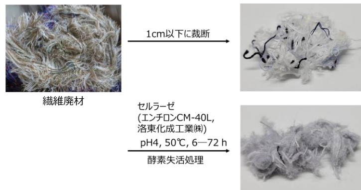
図1 繊維廃材の酵素処理方法
