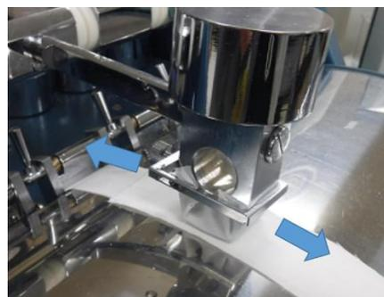
図6 摩擦堅牢度試験の様子
