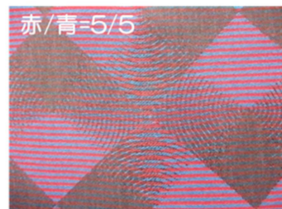
図16 赤糸と青糸を5本ずつ交互に配置 モアレ縞は急激に目立たなくなる
