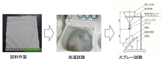
図3 撥水性の評価試験方法
