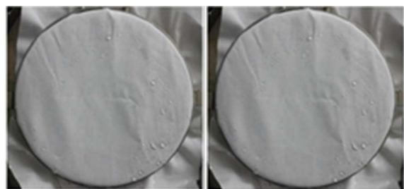
図4 はっ水度試験結果 (左：加工表面、右：裏面)
