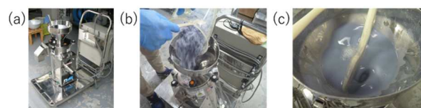
図2 ディスクミルによる機械的解繊の様子。(a) 使用したディスクミル (b) 装置への懸濁液の投入 (c) スラリー状となった試料
