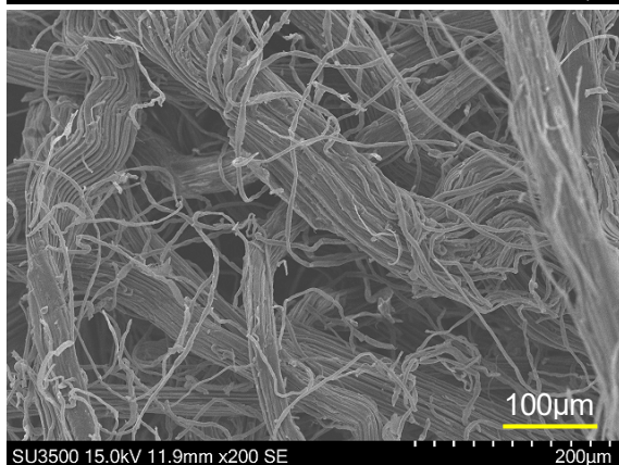
図3 セルラーゼ酵素処理後にアルカリ処理したパイナップル葉繊維
