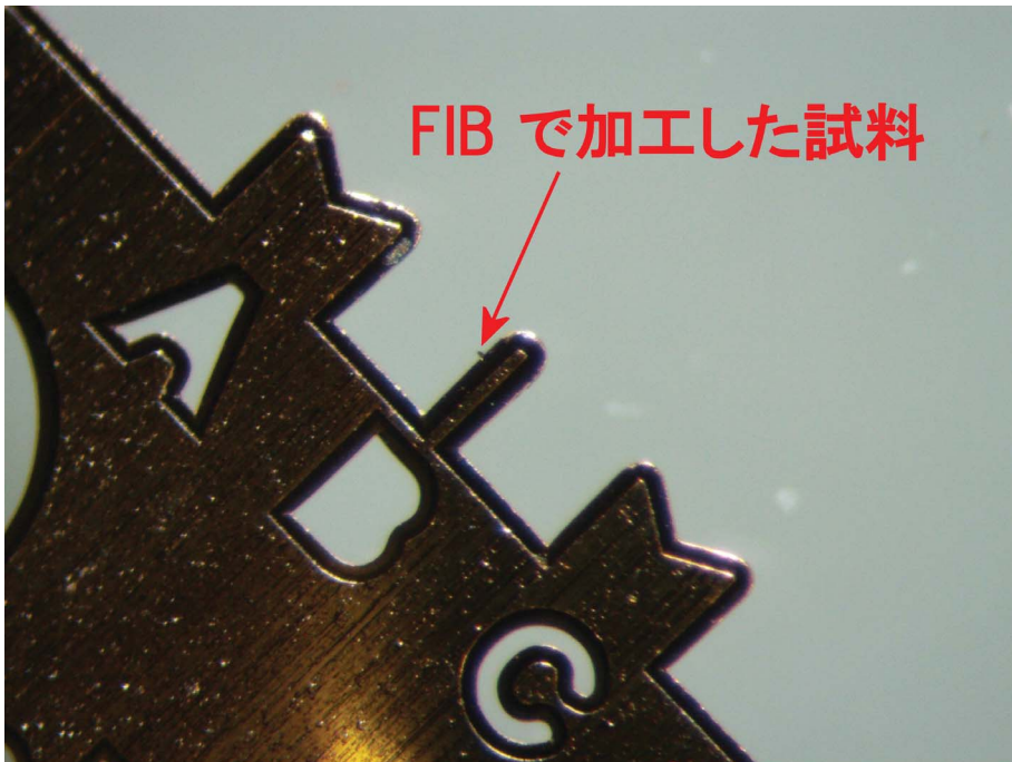
薄片化した試料は、TEM メッシュ上の矢印の位置に固定しています
