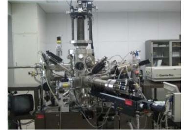
パルスレーザーをターゲットに集光させ、その表面を瞬間的に蒸発させることを繰り返し、対向させた基板上に薄膜を形成する手法で、ターゲットの組成を維持した薄膜が得られやすいという特徴を有しています。
